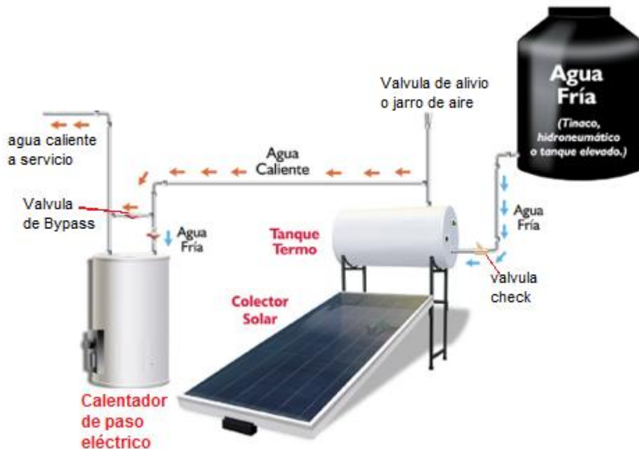
Figura 5.5 Sistema calentador paso eléctrico.
