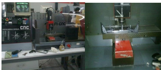
Fig. 16 Maquinado de probetas en máquinas CNC.
