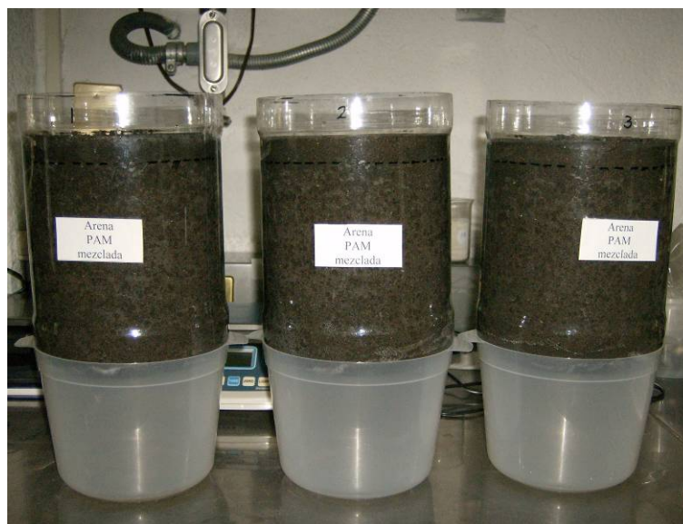
Figura 43. Aspecto de la prueba con la PAM y el arena mezcladas y completamente hidratadas.
