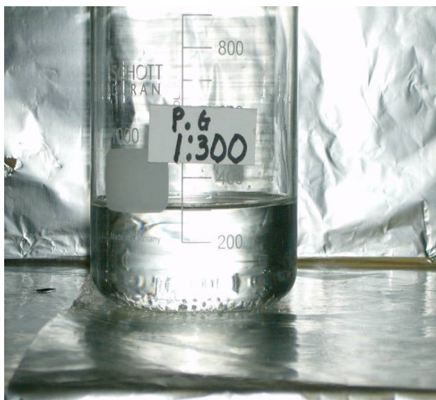
Figura 19. Prueba de hidratación PAM gruesa
