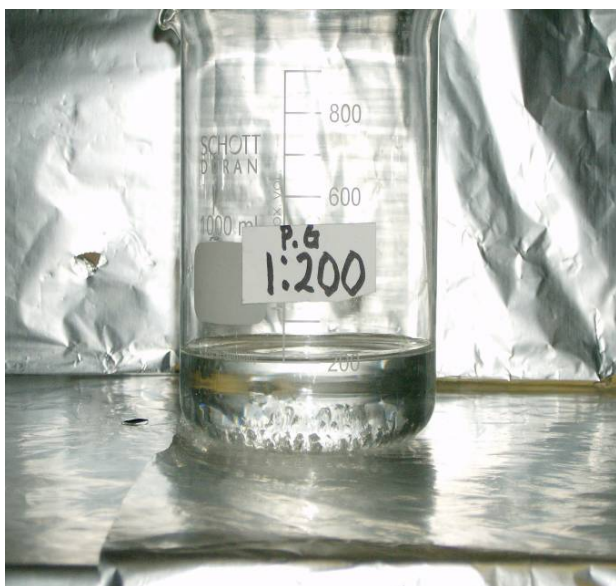
Figura 17. Prueba de hidratación PAM gruesa
