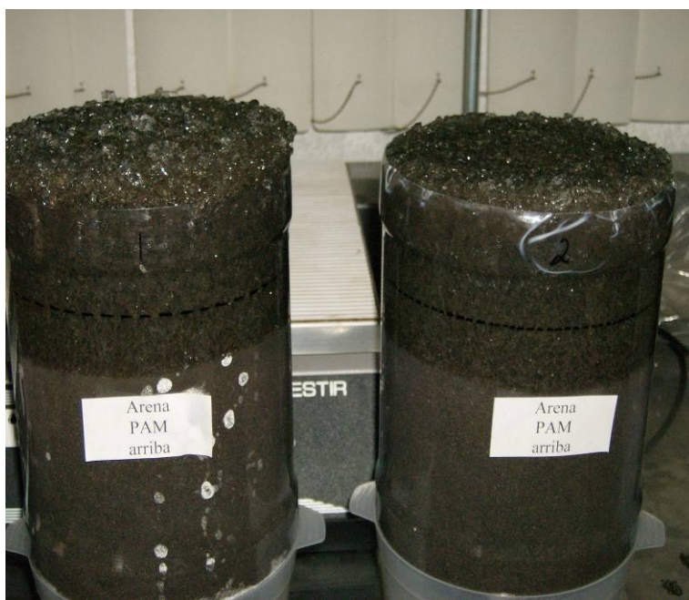
Figura 42. Aspecto de la prueba con la PAM arriba y arena totalmente hidratadas
