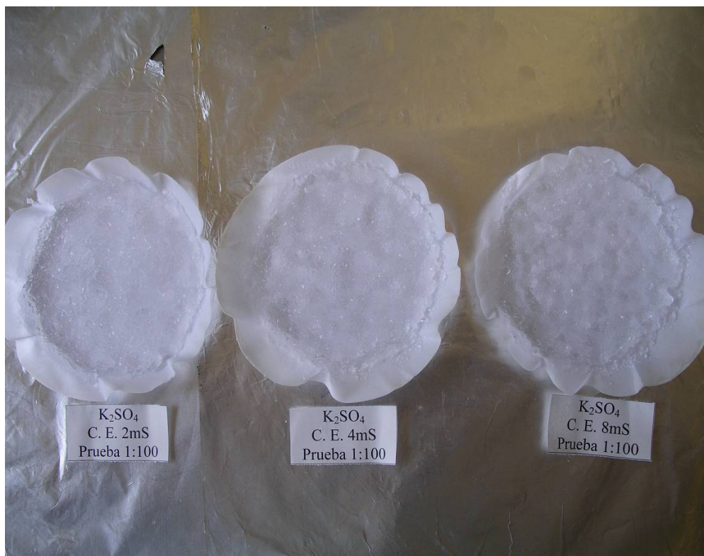
Figura 36. Aspecto de los cristales de PAM hidratados usando soluciones con diferentes cantidades de sal
