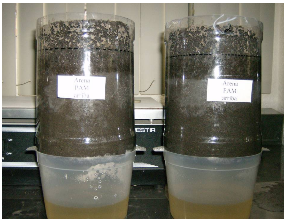
Figura 44. Ejemplo de la prueba de drenado. Prueba PAM arriba
