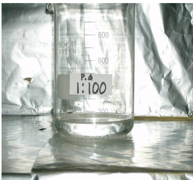
Figura 15. Prueba de hidratación PAM gruesa
