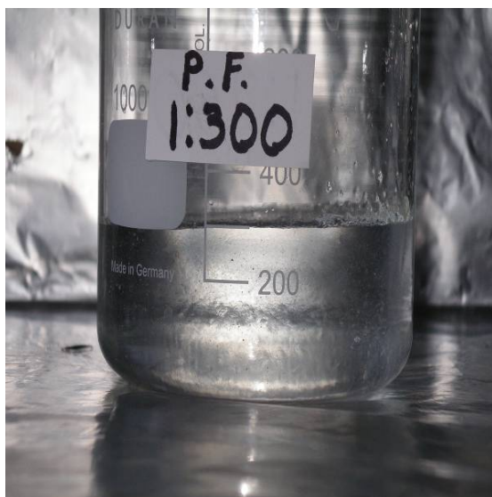
Figura 5. Prueba de hidratación PAM fina
