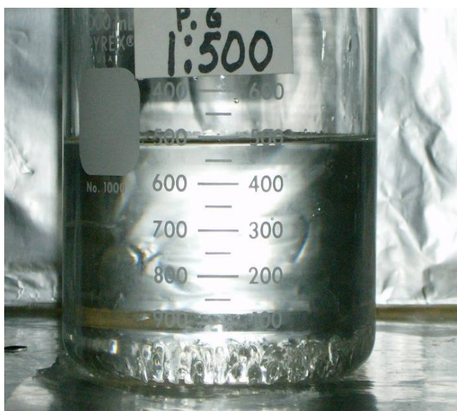
Figura 23. Prueba de hidratación PAM gruesa
