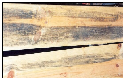
Fig. 2.11 Manchas fungosas en madera de pino.
