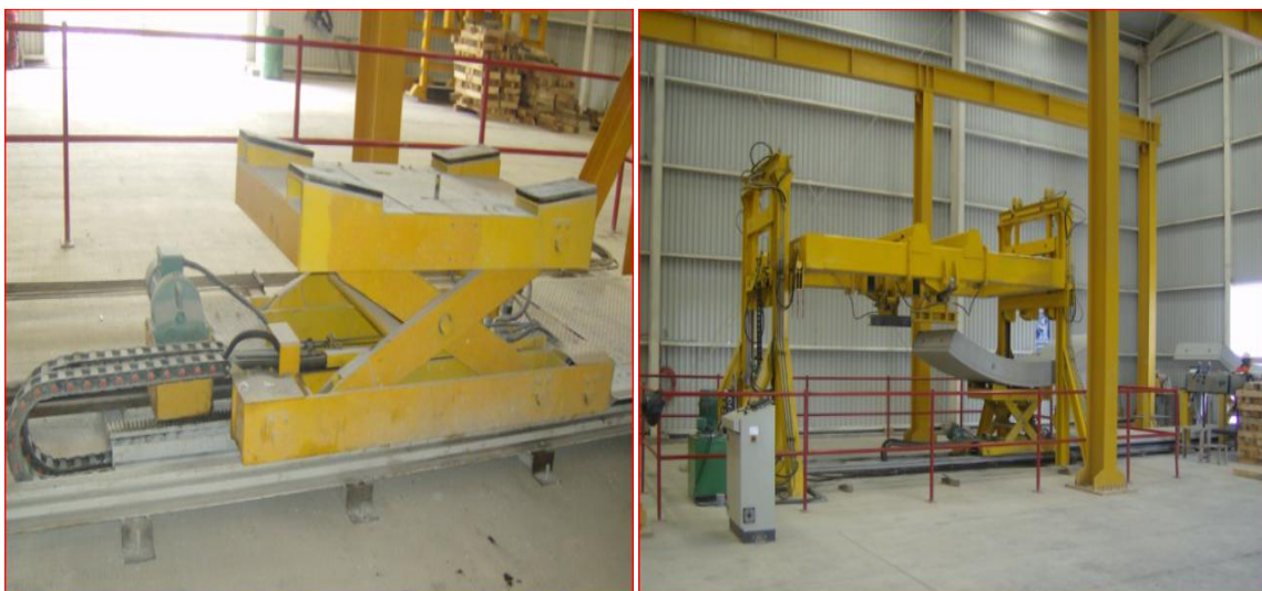
Volteador de dovelas
