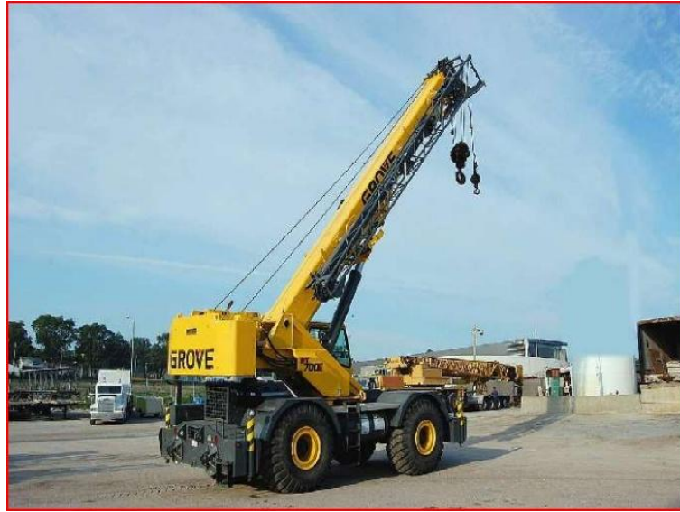
Grúa hidráulica Groove Modelo RT700E con capacidad para 60 toneladas, ubicada en patio de planta.
