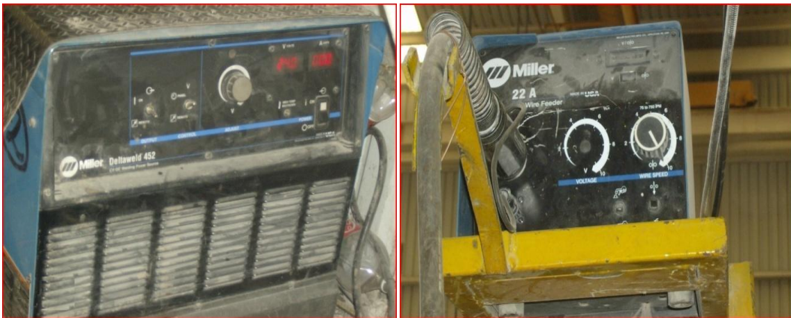
Maquina de para soldar de la marca Miller, y alimentador de alambre de la misma marca
