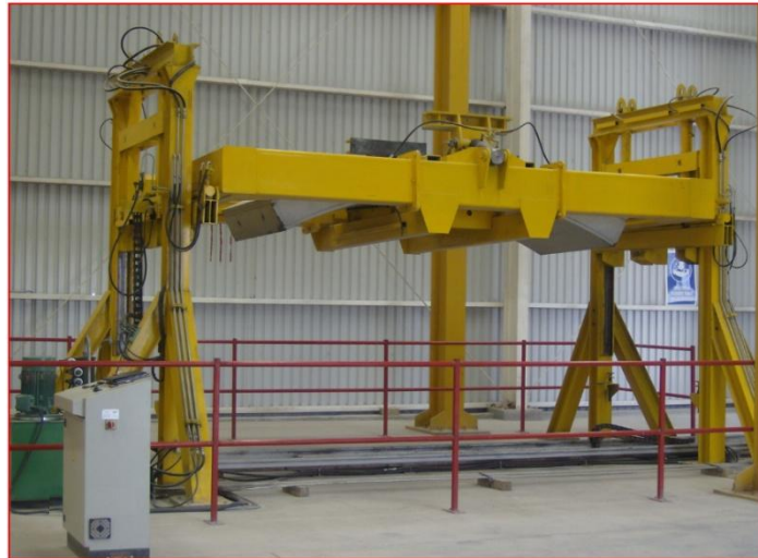
Volteador de dovelas
