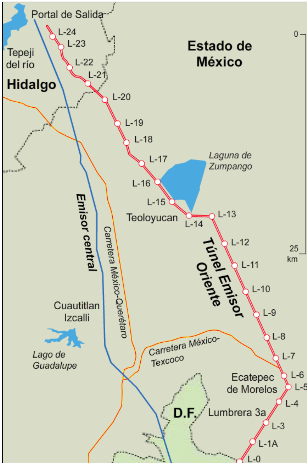
Figura 3.- Trazo en planta del TEO. Se muestran sus 24 lumbreras y el portal de salida, en Hidalgo. La mayor parte de la obra se localizará dentro del Estado de México.
