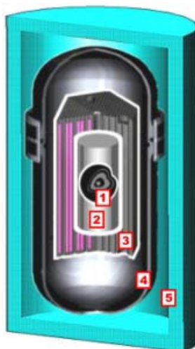
Figura 1.42. Barreras de protección. [21]
