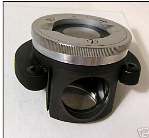
Figura 2.10. Diafragma de campo comercial (Carl Zeiss)
