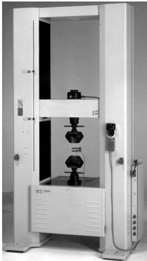
Fig.4.4 Imagen de la máquina de prueba universal Shimadzu AG- 100 kNx utilizada en las pruebas de compresión flexión.
