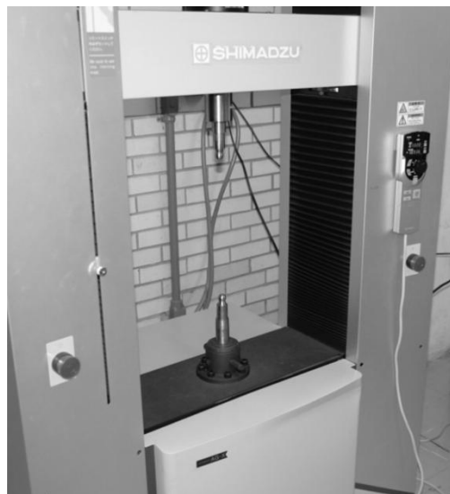
Fig.4.6 Fotografía que muestra los aditamentos que se diseñaron y manufacturaron para poder realizar la prueba de compresión-flexión en la máquina de prueba universal Shimadzu® AG- 100 kNx
