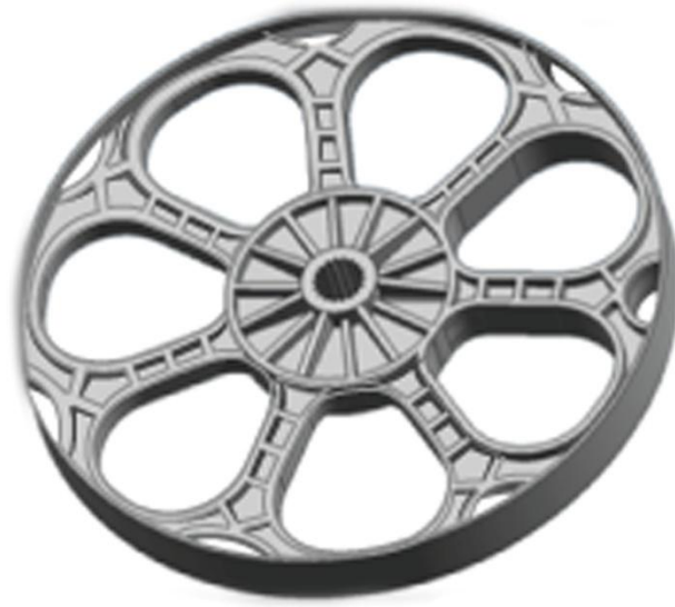
Figura 15. Rediseño 1, primera iteración del modelo geométrico.
