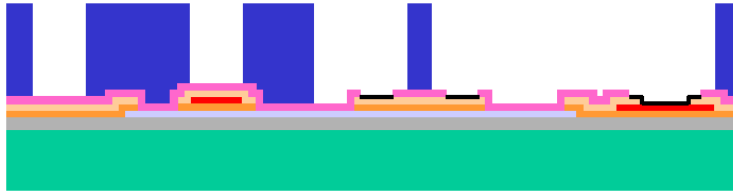
Figura 2.8. Se deposita una capa de 500 nm de Cobre + 50 nm de Titanio denominada base plateada. La oblea se recubre con una capa gruesa de material fotorresistente y se graba utilizando la mascara METAL. Este proceso forma el patrón para la capa de Metal electroplateado.
