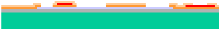
Figura 26. Las obleas son cubiertas con fotorresistente y se graban las capas de nitruro de silicio utilizando litografía y la máscara de NITRHOLE. El ataque es de tipo RIE. Las áreas de Nitruro1 permanecen si se encuentran debajo del polisilicio.
