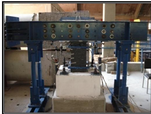
**Fig. 3.5.4** *Especimen reforzado con fibras de carbono*
