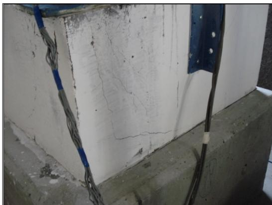
Fig. I.19 Agrietamientos en la base del espécimen
