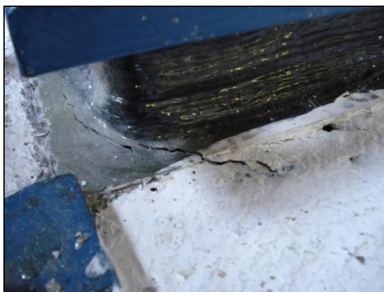
Fig. I.17 Agrietamientos en la unión del espécimen y la base
