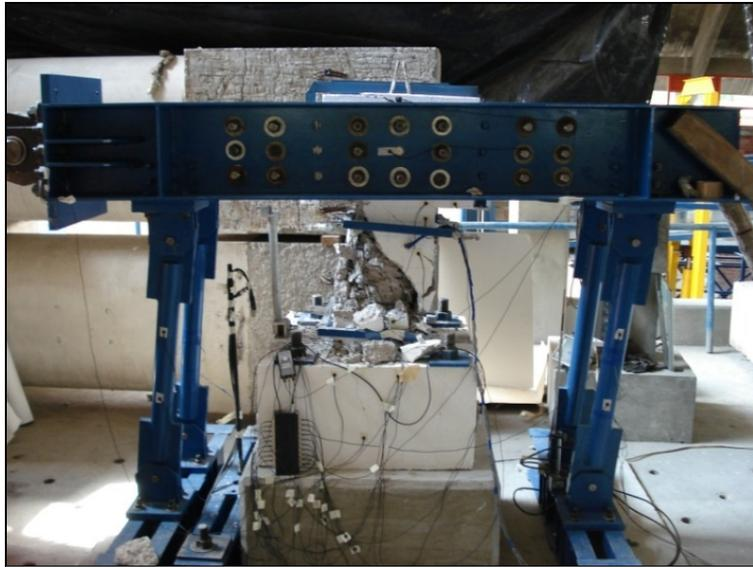
Fig. I.10 Aspecto del espécimen EF1 después del ensayo
