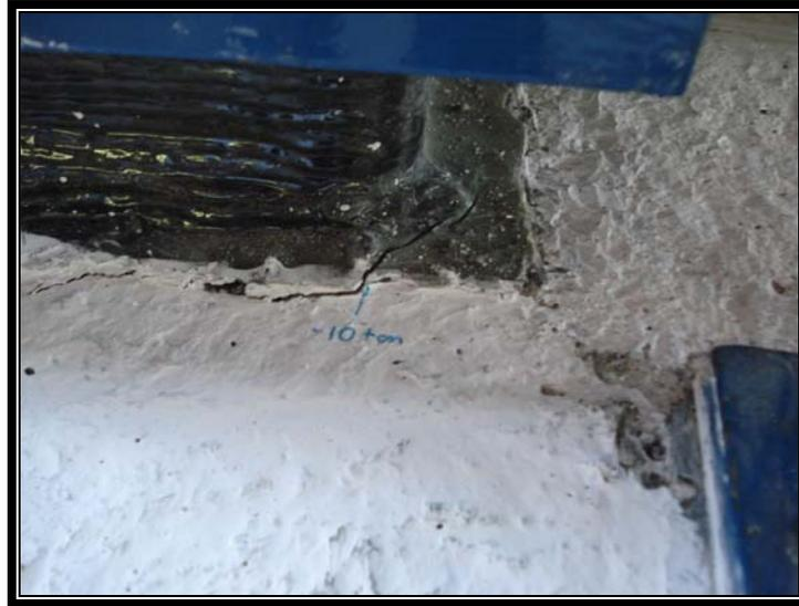
**Fig. 5.3.3 Deterioro de las zonas adyacentes al puntal FG en el espécimen ER1**
