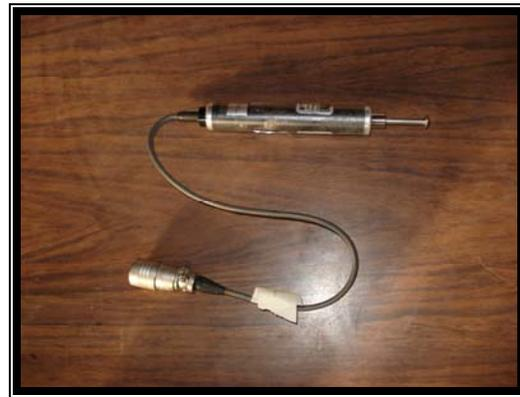
**Fig. 4.2.3 DCDT empleado en el ensaye 2 espécimen EF1**
