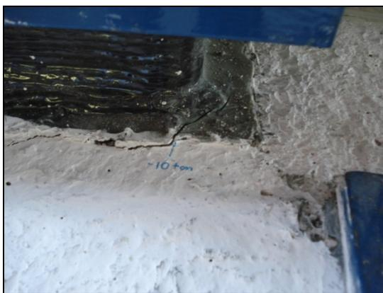
Fig. I.18 Agrietamientos en la unión del espécimen y la base
