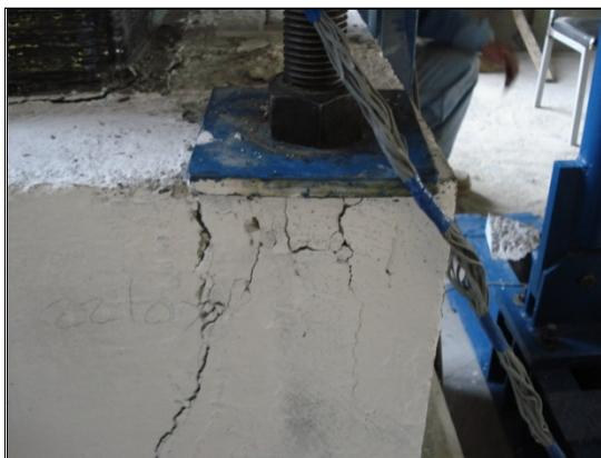
Fig. I.20 Agrietamientos en la base del espécimen
