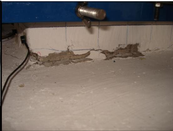
**Fig. 1.5** Aplastamiento del concreto en la base del espécimen
