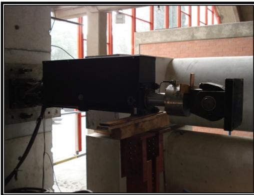
**Fig. 3.5.1 Actuador hidráulico**
