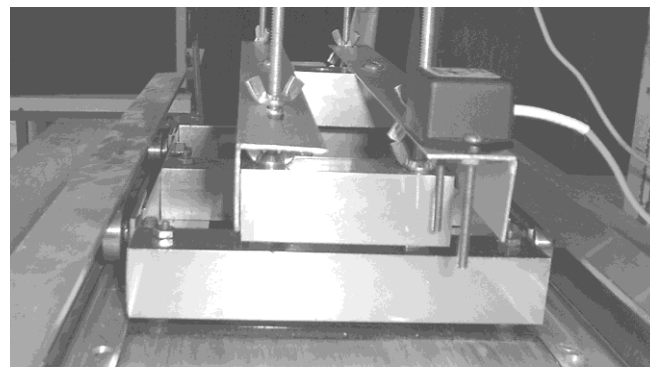
Figura 3.7 Sistema de guía vertical Foto 3.6 Base del modelo, sistema de guía vertical
