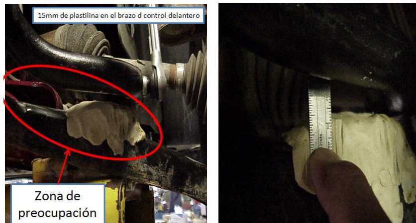
Fig. 38 Plastilina aplicada al brazo de control antes de la prueba en topes.
