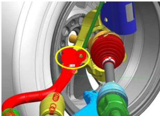
Fig. 28. Contacto de de la caja de dirección externa con la barra en máxima extensión y giro.
