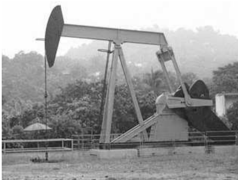
Figura 1.4 – Sistema Artificial de Producción: Unidad de Bombeo Mecánico
