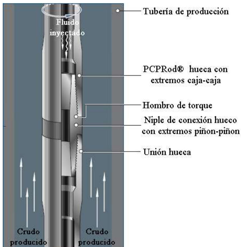
Figura 4.3 Esquema de unión de la PCPRod®.
