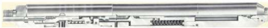
Figura 2.7 Válvula convencional para flujo intermitente con carga de nitrógeno en el fuelle (CAMCO CP-2).
