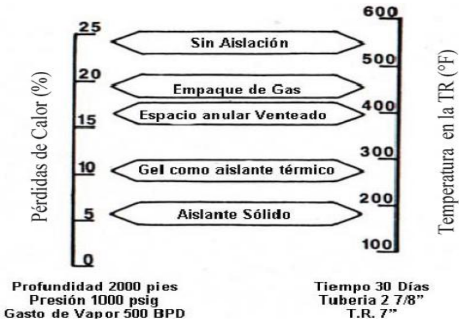
Figura 3.10 Comparación de las pérdidas de calor de los diferentes tipos de aislación térmica
