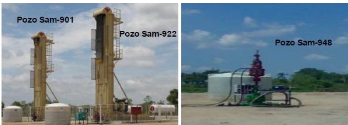
Figura 4.13 Esquema de producción en frío con inyección con diluyente; BM y BCP
