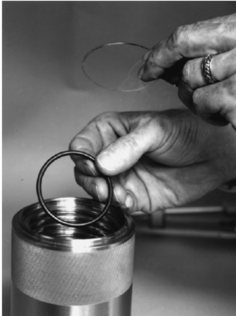
Instalación del aro-sello y su respaldo
