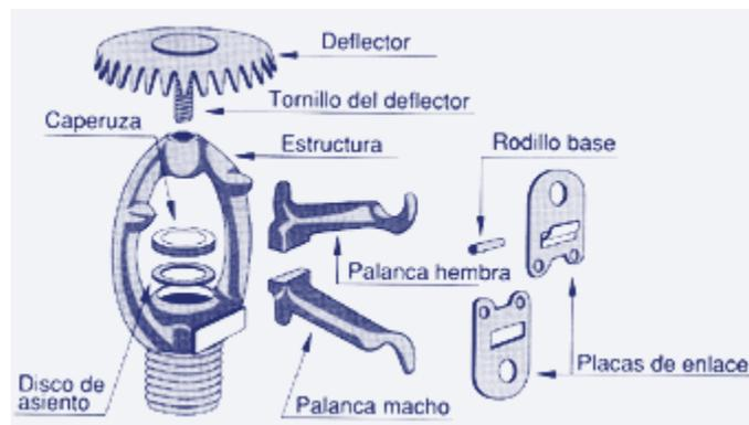
Fig. 3.2 Muestra de la disposición de las piezas de un rociador automático de enlace fusible
