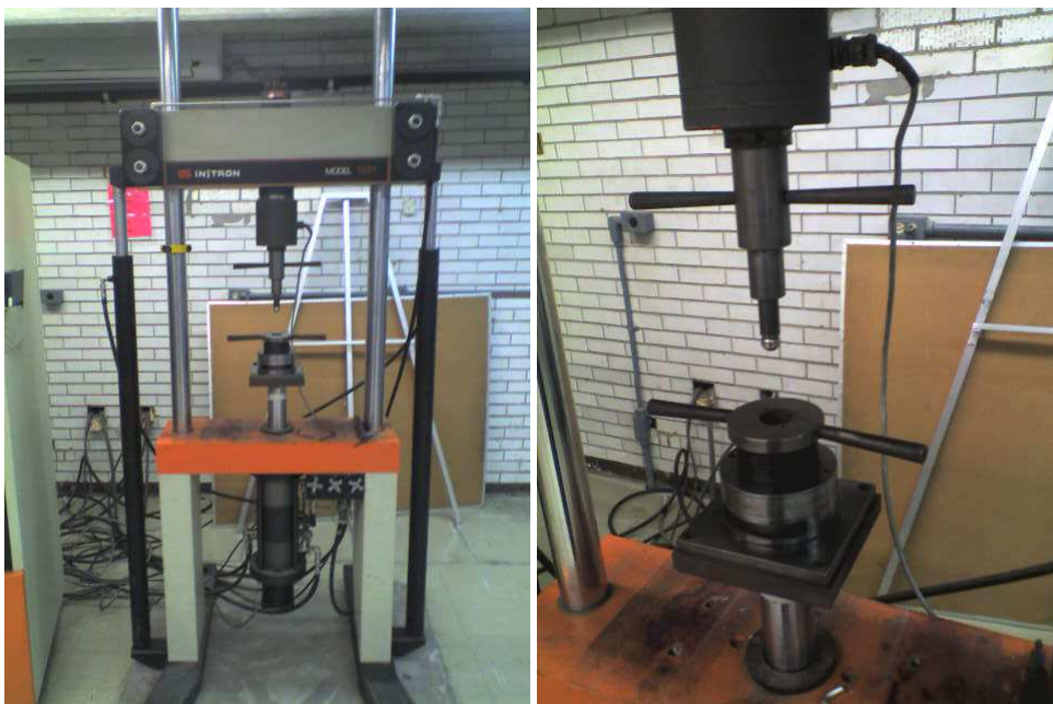
Fig. 3.24. Montaje del herramental en la máquina de pruebas Instron.
