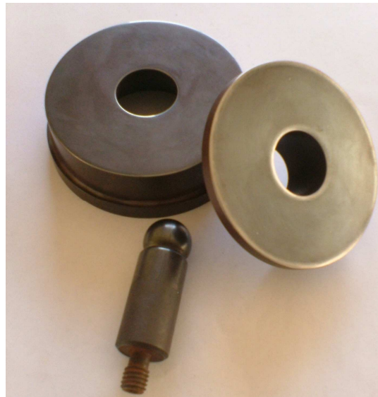
Fig. 3.10. Dados y punzón posteriores a la nitruración.
