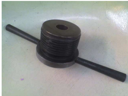
Fig. 3.23. Ensamble del dado superior.
