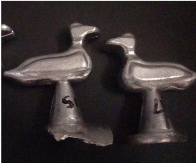
**Figura 2.28** Piezas obtenidas con una temperatura del aluminio de 800° C y sin reducción del diámetro en la entrada de la cavidad, donde se observa que el defecto continúa pero en menor proporción.
