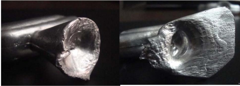
Figura 2.29 Revisión de coladas, aquí se observa que el rechupe se da en mayor proporción que en los casos anteriores, lo que nos indica que la mazarota realiza su tarea de forma adecuada
