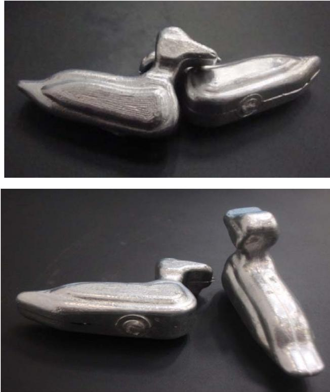
**Figura 2.33.** Pieza obtenida con las líneas de respiración de una de las placas, con barrenos en la parte lateral de la cavidad, una temperatura del aluminio de 800º y reducción en la entrada de la cavidad.
