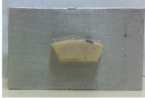
Figura 3.4. Sujeción de las muestras de hueso
