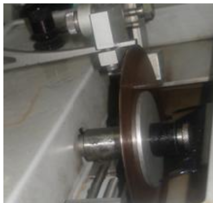
Figura 2.1. Cortes de las probetas con disco de diamante.
