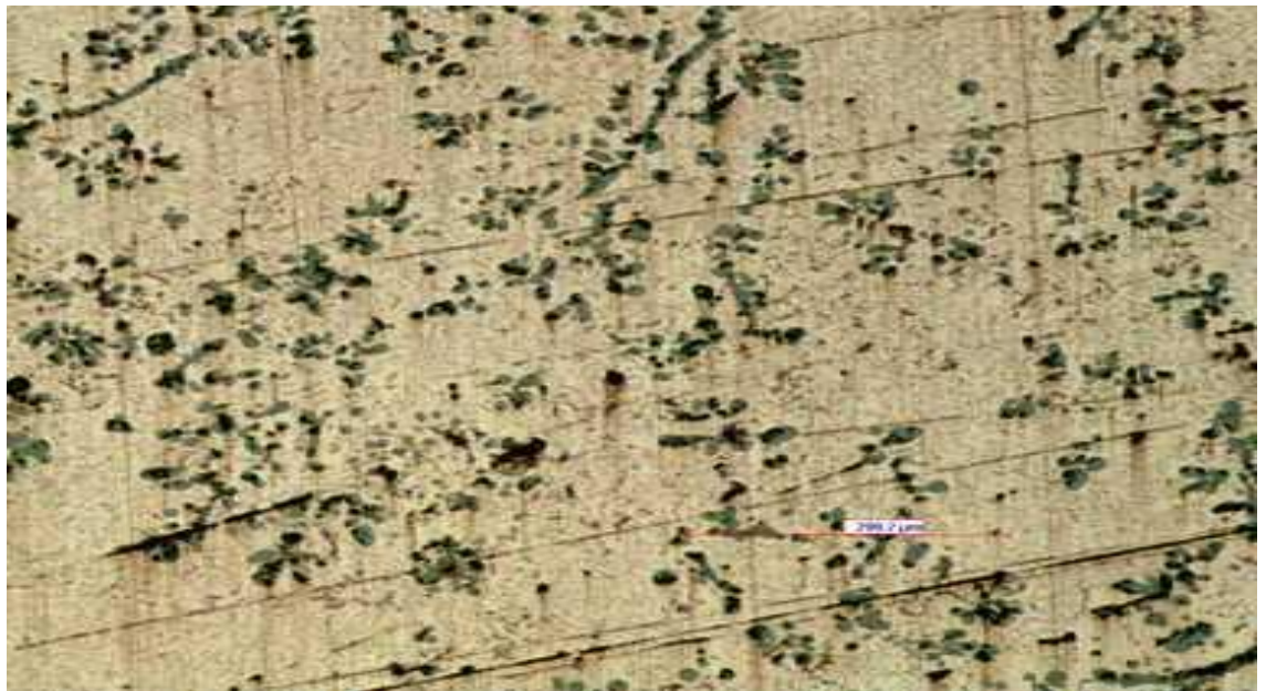
En la siguiente Fig.5.8. se observada en el microscopio óptico a 100 aumentos se muestra el cobre de color naranja y el hierro en una forma muy peculiar como ramificaciones de color gris y en un área de 500\mu\text{m} alrededor de 8 poros lo que es poco en comparación con otras piezas, precalentamiento 1000^{\circ}\text{C}
