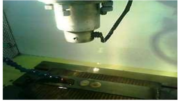
Fig. 5.54. Electroerosionadora de penetración modelo EDM440nc serie L
