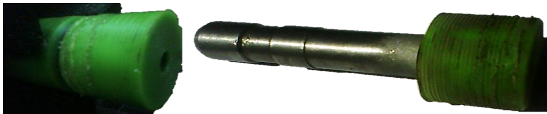
Fig. 5.41 de la barra de nylamid a la izquierda, a la derecha el porta electrodo y el electrodo de Nylamid
