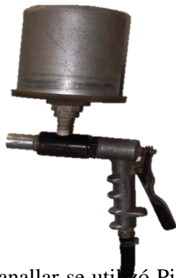
Fig. 1.7 Pistola para granallar mediante un sistema de succión utilizada para este trabajo.
