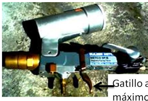
Fig. 4.13. Pistola con el gatillo pasando el primer tope
