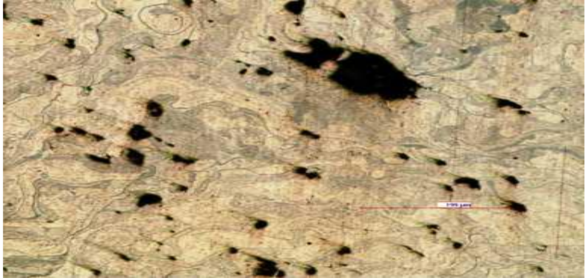
Fig. 5.19. Por ser de las primeras pruebas que se elaboraban se observa a 100 aumentos sobre el cobre proyectado se alcanza a ver que es más porosa se pudieron contar en un área de 500\mu\text{m} \times 500\mu\text{m} 24 poros y además más uniforme en todo el cobre no sólo en la superficie
