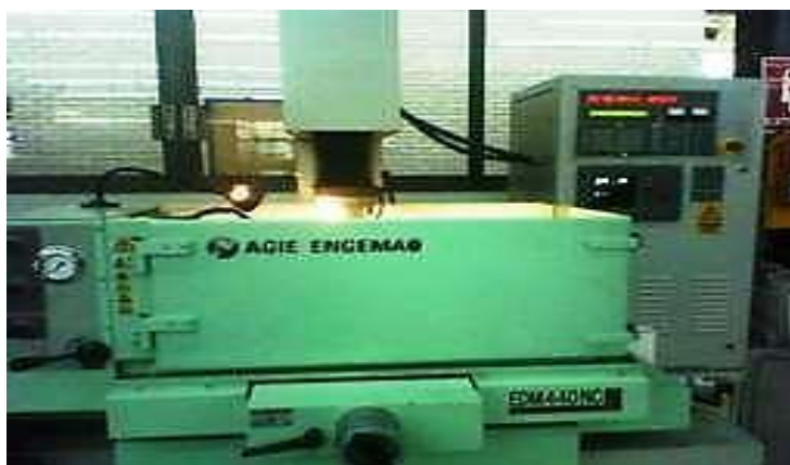
Fig. 5.53. Fotos de Electroerosionadora de penetración utilizada.
