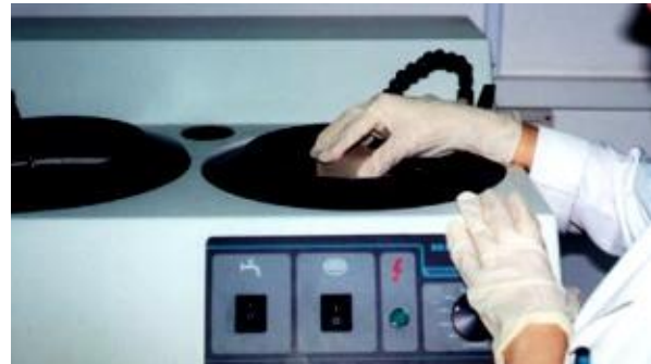
Fig. A2.4: ala izquierda se encuentra Pulidora metalográfica con cabezal de pulido automático y ala derecha de forma manual
