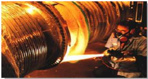
fig.2.14. Proyección en el interior de una turbina
