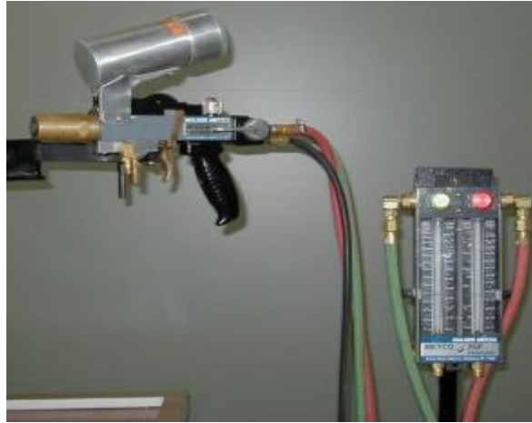
Fig. 2.7 Equipo de rociado térmico por flama (pistola 5P-II con fluxómetro)
