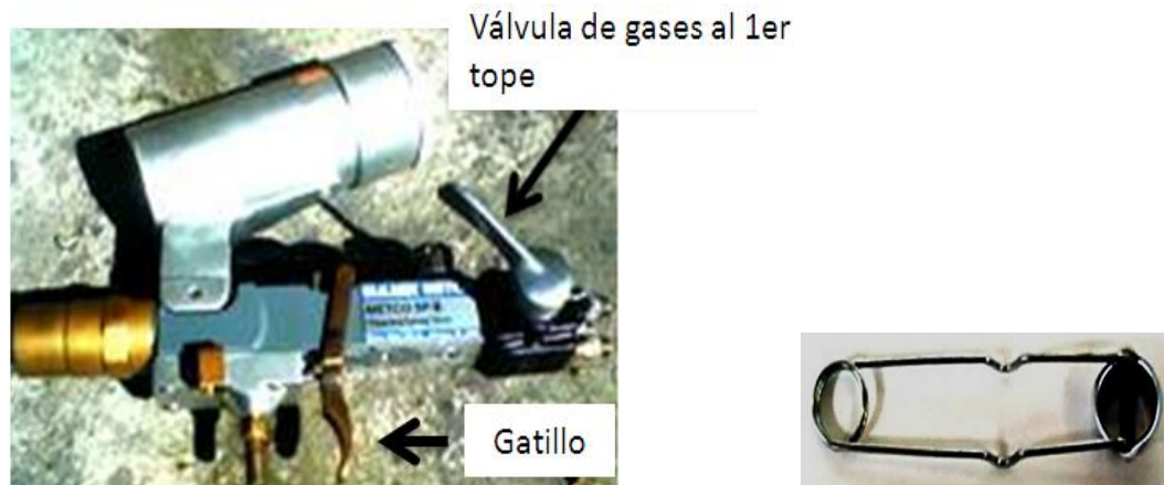
Fig. 4.12. Se observa a la izquierda la pistola con el gatillo hasta el primer tope y a la derecha un chispero común
