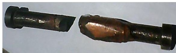
Fig. 5.38. Del proceso de elaboración de la probeta parecida a la anterior, pero en esta al final se recubre en un torno abarcando mayor área de contacto
