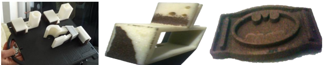
Fig.6.1 Ejemplos de prototipos rápidos a la izquierda, prototipo semirecubierto con cobre y a la derecha una pieza proyectada con cobre con la pistola de polvos, la cual se deformó un poco
