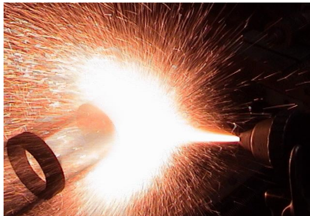
Fig. 2.5 Foto de aplicación de acero inoxidable sobre una superficie de acero 1018
