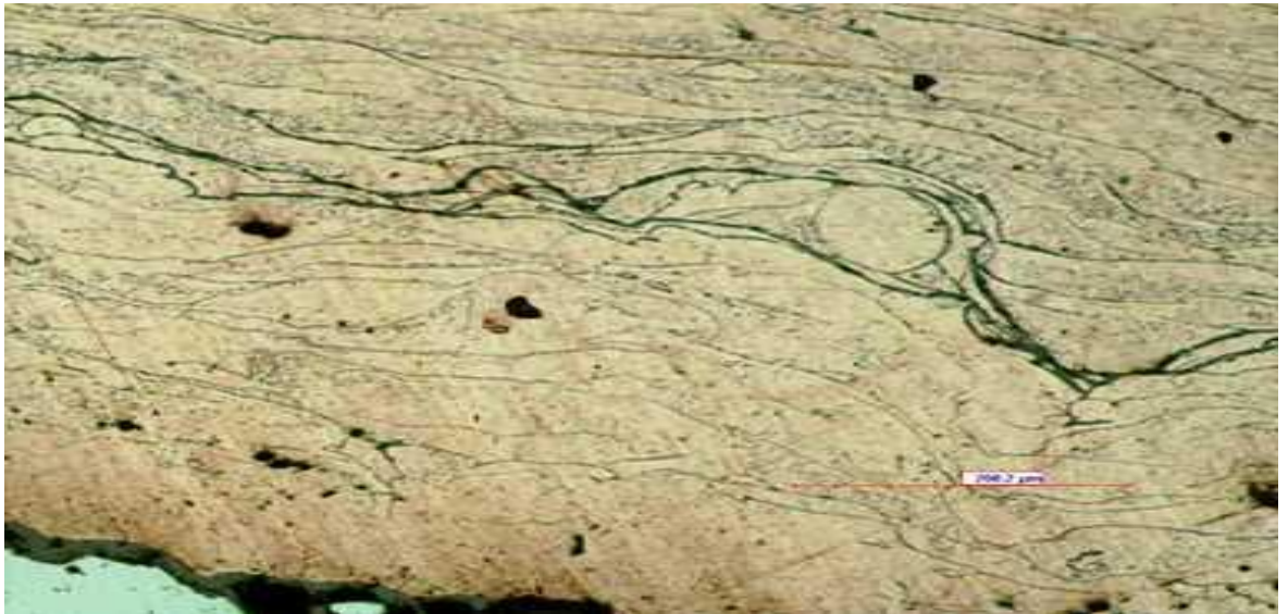
Fig. 5.13. Además se ve a 100 aumentos cuatro poros en un área de 500\mu\text{m} \times 500\mu\text{m} y además se alcanza a ver una microporosidad de baja dimensionalidad
