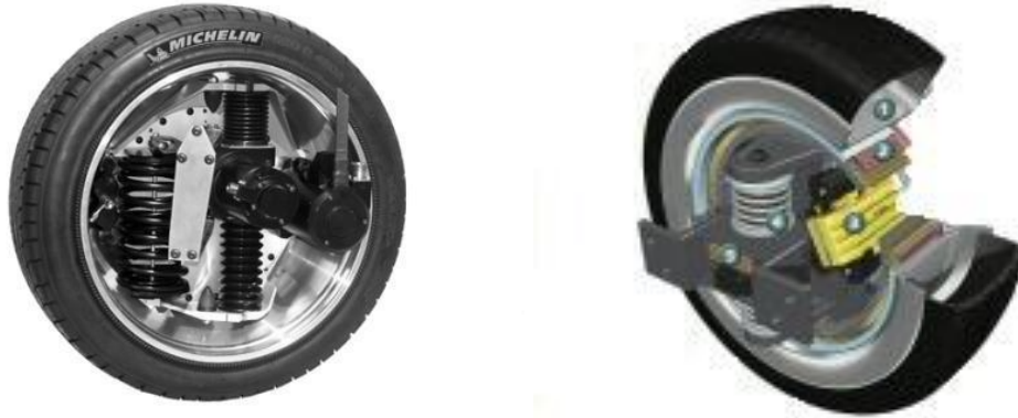
Figura 94. Active Wheel de Michelin (61) y VDO de Siemens (62)
