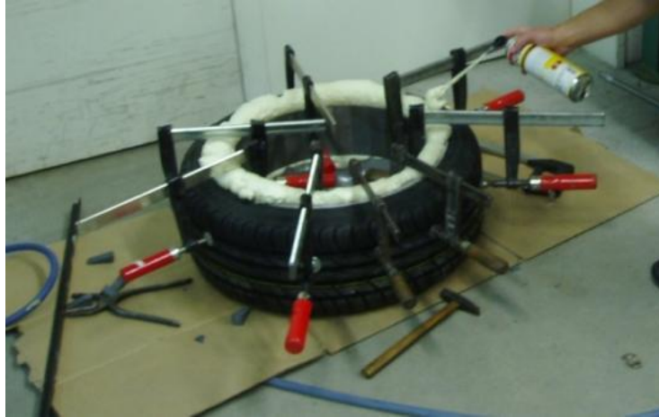
Figura 122. Ensamble del rotor y del rin
