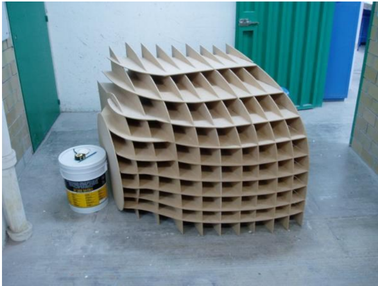
Figura 109. Estructura de madera para obtener los moldes
