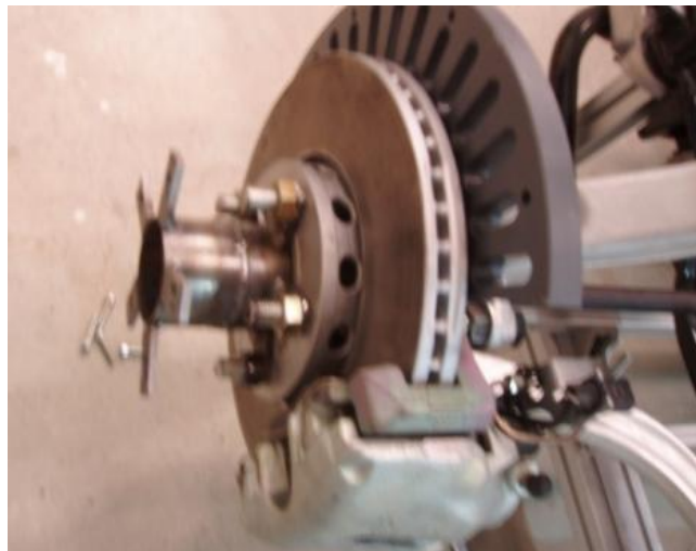
Figura 123. Estator y freno montado en el eje
