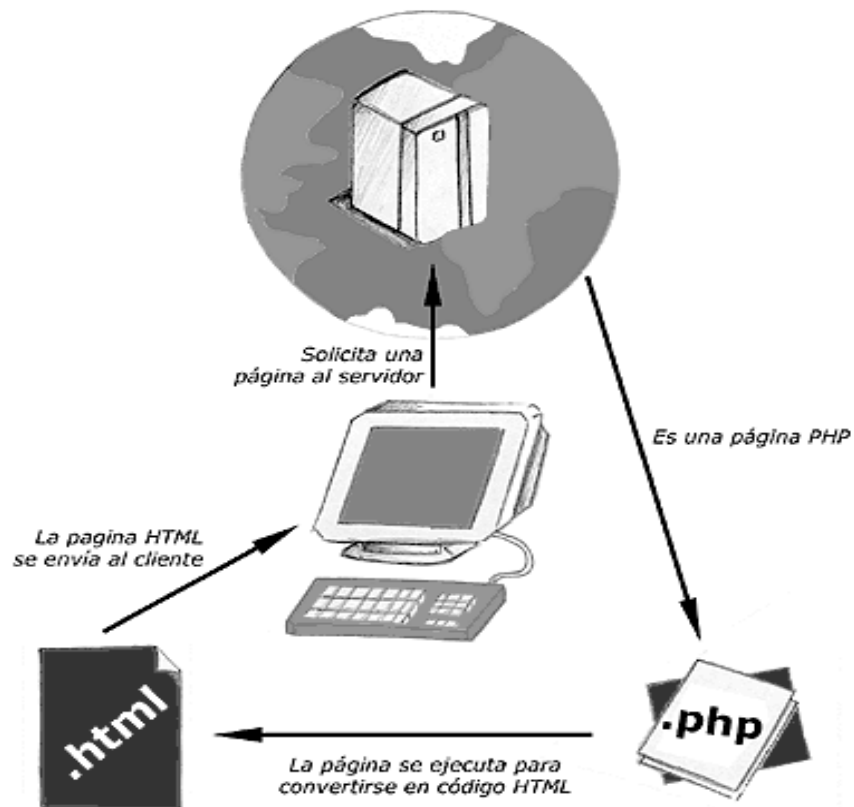
Figura 2.3.1.1. Esquema del funcionamiento de PHP
