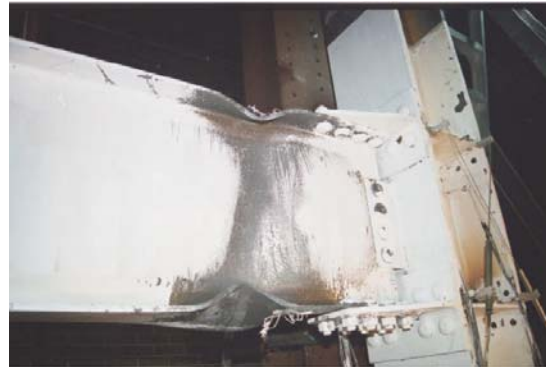
b) Articulación plástica de la viga
