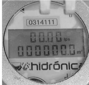
**Figura 2.9 Registro electrónico de un medidor de propela.**
