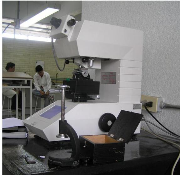
**Figura 3. 10: Microdurómetro.**
