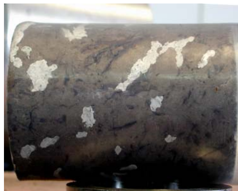
Fig. 4.2. Vista lateral del núcleo con los vóculos rellenos de teflón
