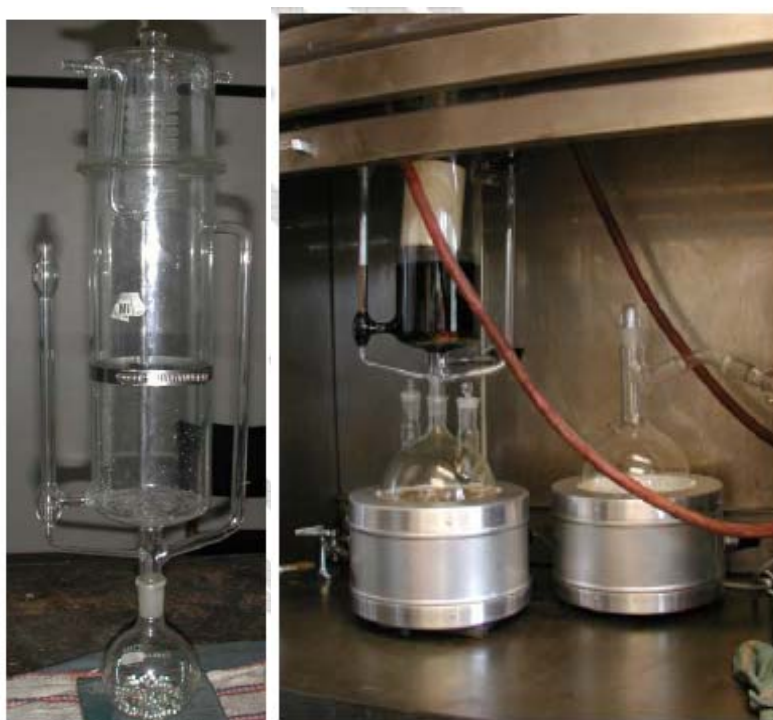
Fig. 4.1 Celda de destilación para limpiar núcleos de diámetro completo. Izquierda, vista de la celda completa. Derecha, celda dentro de campana limpiando un núcleo.
