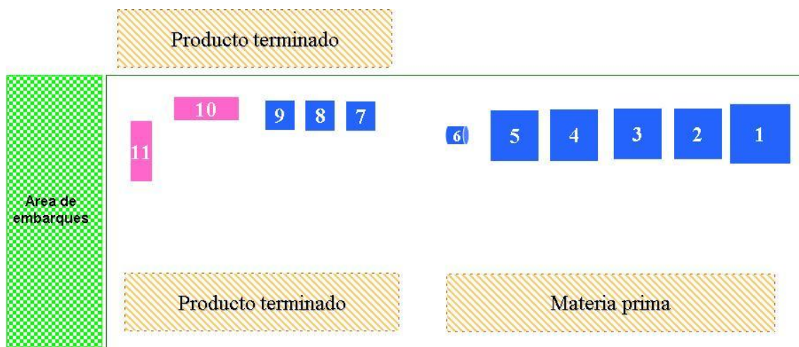
Figura 34. Nuevo Layout de la nave de producción.
