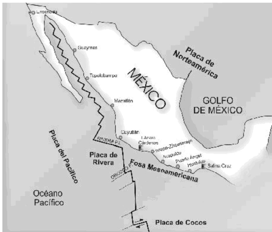
Figura 2.4 Escenario sismo-tectónico de la costa del Pacífico de México (Farreras et al., 2005).
