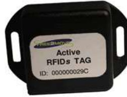
Figura 2.15.- Componentes de un sistema RFID activo propietario
