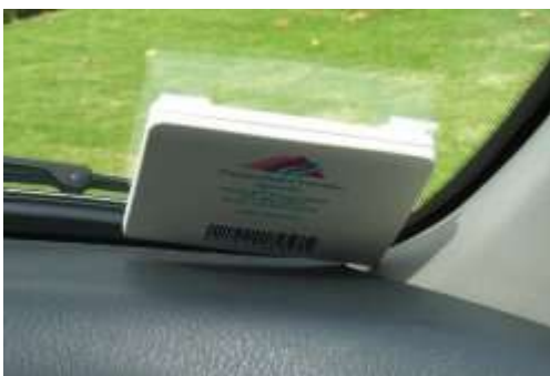
Figura 2.2.- Etiqueta RFID empleada para la peaje electrónico.
