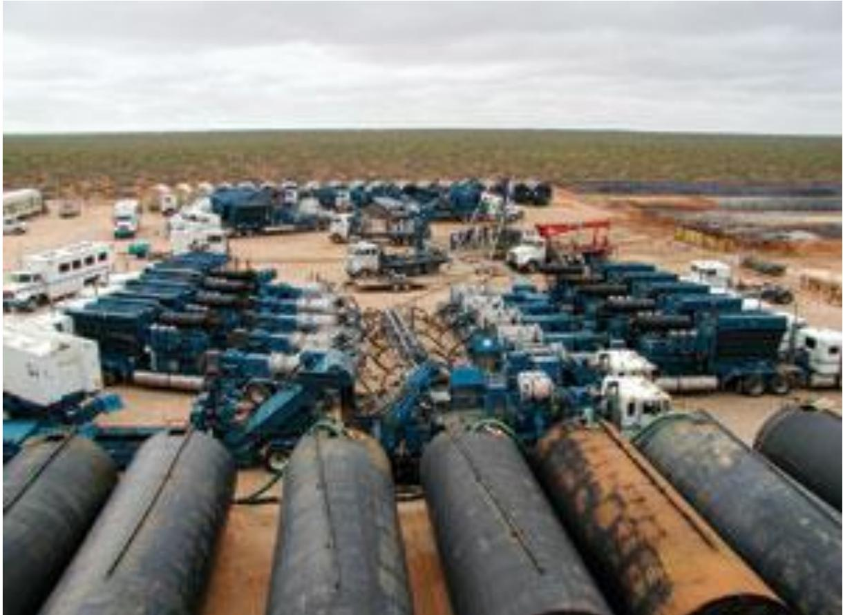
Figura III.4.1. Instalación de un equipo para realizar un fracturamiento hidráulico
