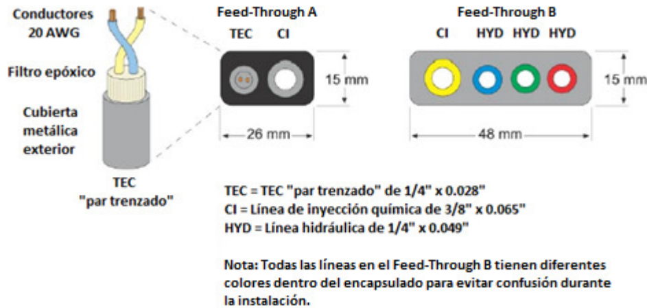
Figura 4.23 Configuración de las líneas de control en Feed-Through para IWS en EY-D11 4 .
