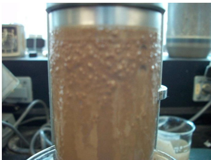
Figura 9: Sólidos Adheridos a la Superficie de un Cilindro Metálico
