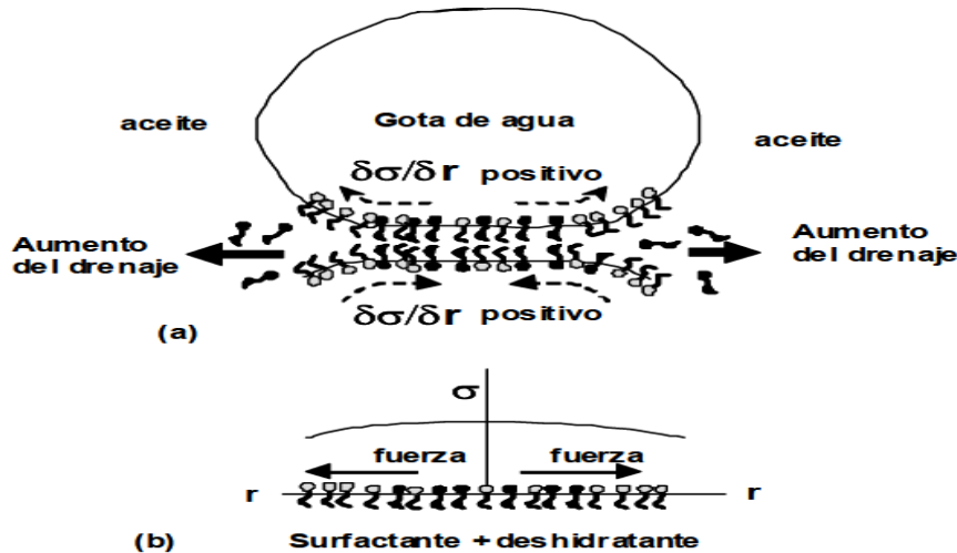
Figura 2-6 (a) Ilustración esquemática de la adsorción del surfactante deshidratante en la superficie libre de la película. (b) Efecto de la concentración superficial del surfactante natural y las moléculas de deshidratante sobre la variación de la tensión interfacial 8 .
