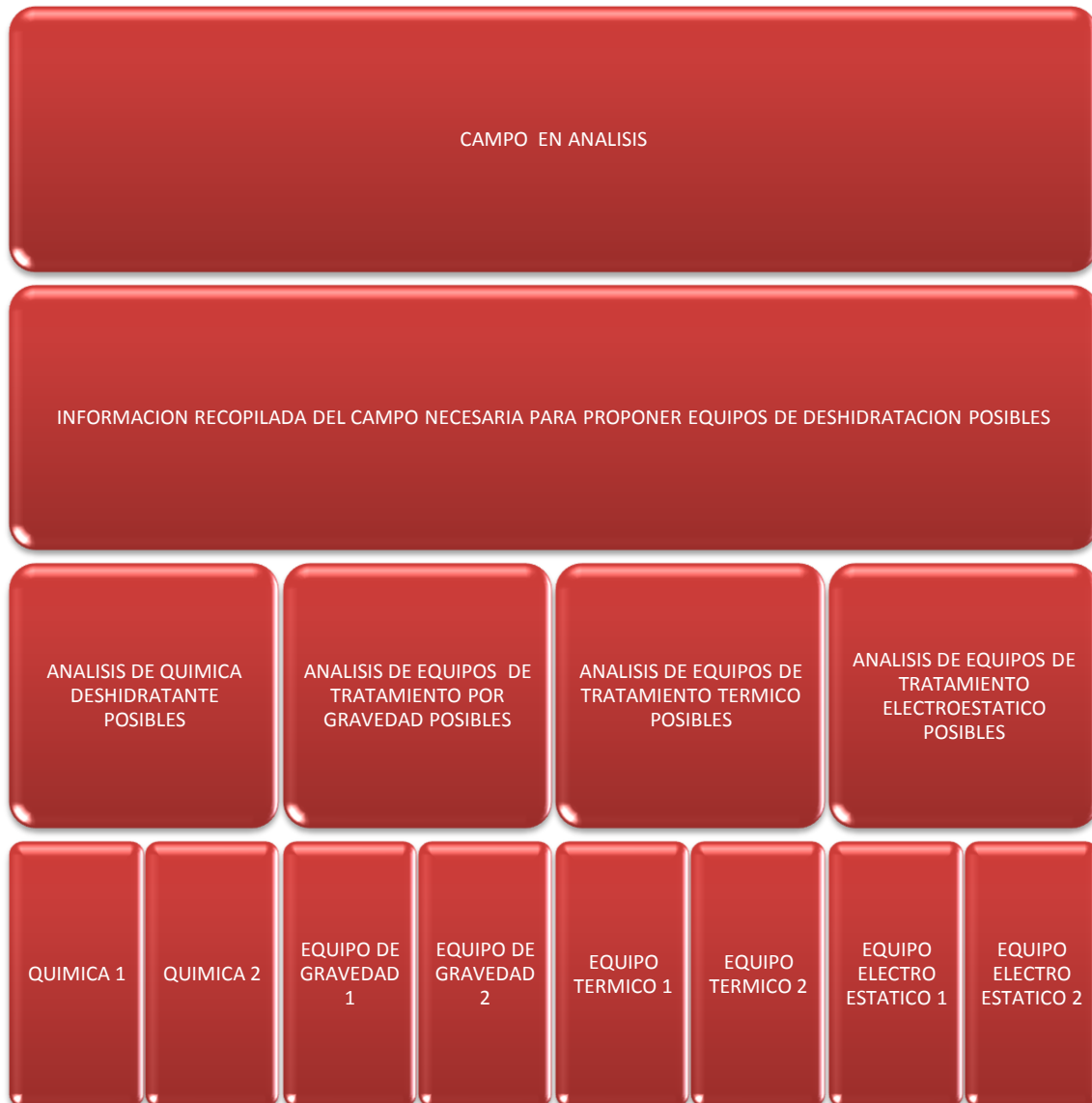
Figura 4-16 Proceso de generación de alternativas de equipos posibles de deshidratación en base a la información recopilada.
