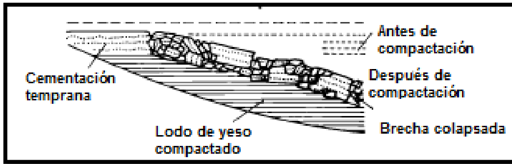
Fig. 2.18 Brecha colapsada causada por la cementación temprana en capas superiores y compactación diferencial subsecuente (Langbein, 1987).
