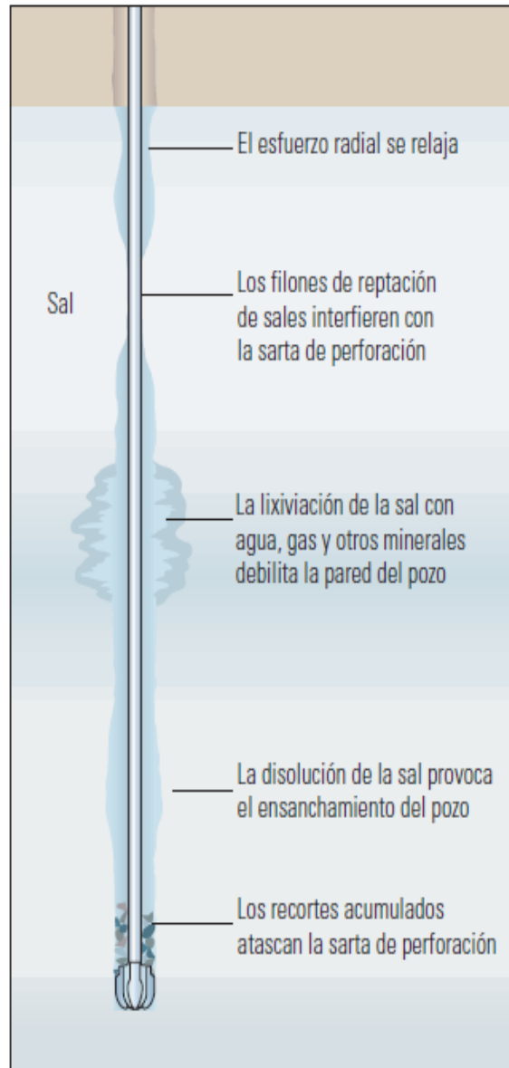
Fig. 4.9. Derrumbes. Problemas asociados con la selección deficiente del fluido de perforación (Sculmberger, 2008).
