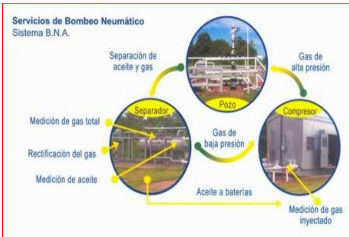
Fig. 1.25.- Principio de operación del BNA. Fuente: ENX
