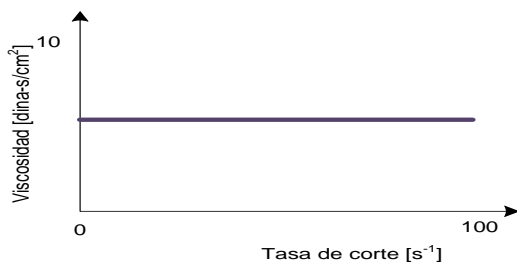
Figura 5.2.3. Gráfica de \mu vs \dot{\gamma} para un fluido Newtoniano ideal.
