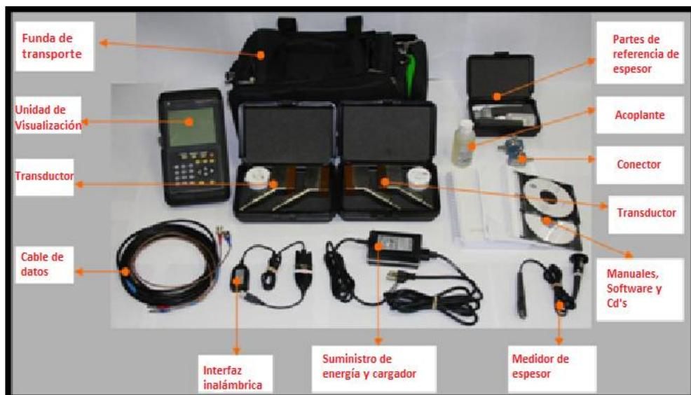
Ilustración 5-2 Medidor ultrasónico tipo Clamp-on
