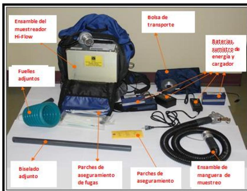
Ilustración 5-1 Muestreador de flujo de alto caudal (Hi-Flow)
