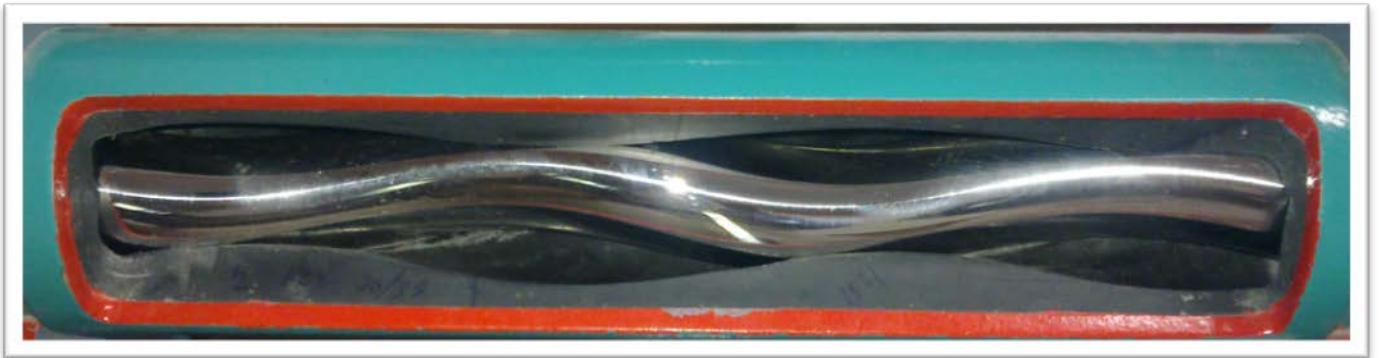
Figura II-20 Bomba de cavidades progresivas.
