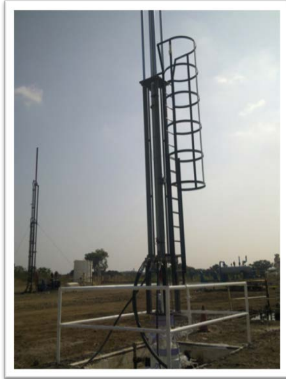
Figura II-15 Unidad Morlift de bombeo mecánico.
