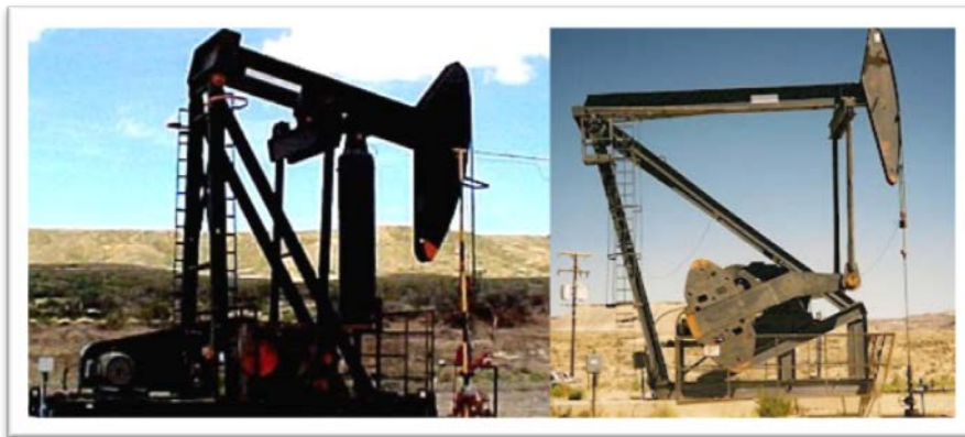
Figura II-11 Unidades superficiales de bombeo mecánico de balancín clase III aerobalanceada (izquierda) y Mark II (derecha).
