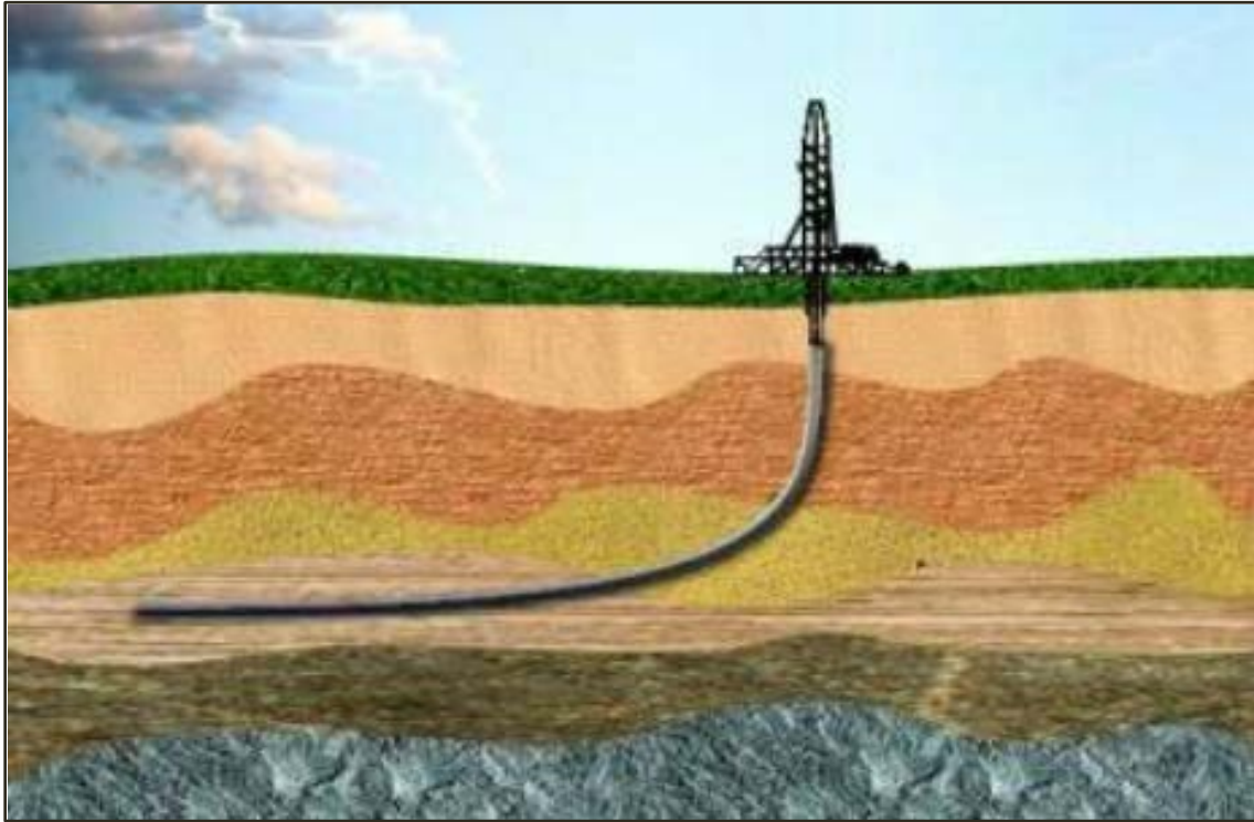
Figura 5.2 Diagrama de un Pozo horizontal (Tomada de CNH, 2011).
