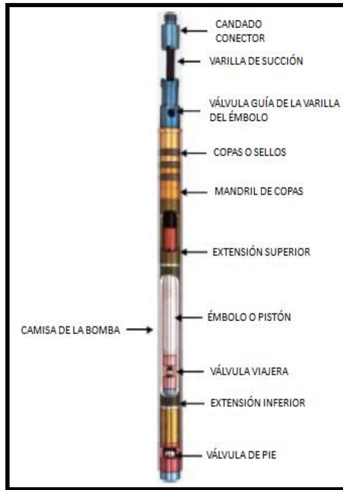
Figura 1.7 Componentes de una bomba subsuperficial de BM.
