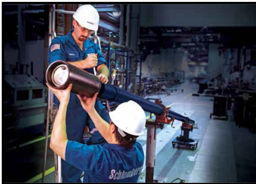
Figura 4.9. Llenado del Motor REDA Maximus en el centro de manufactura.
