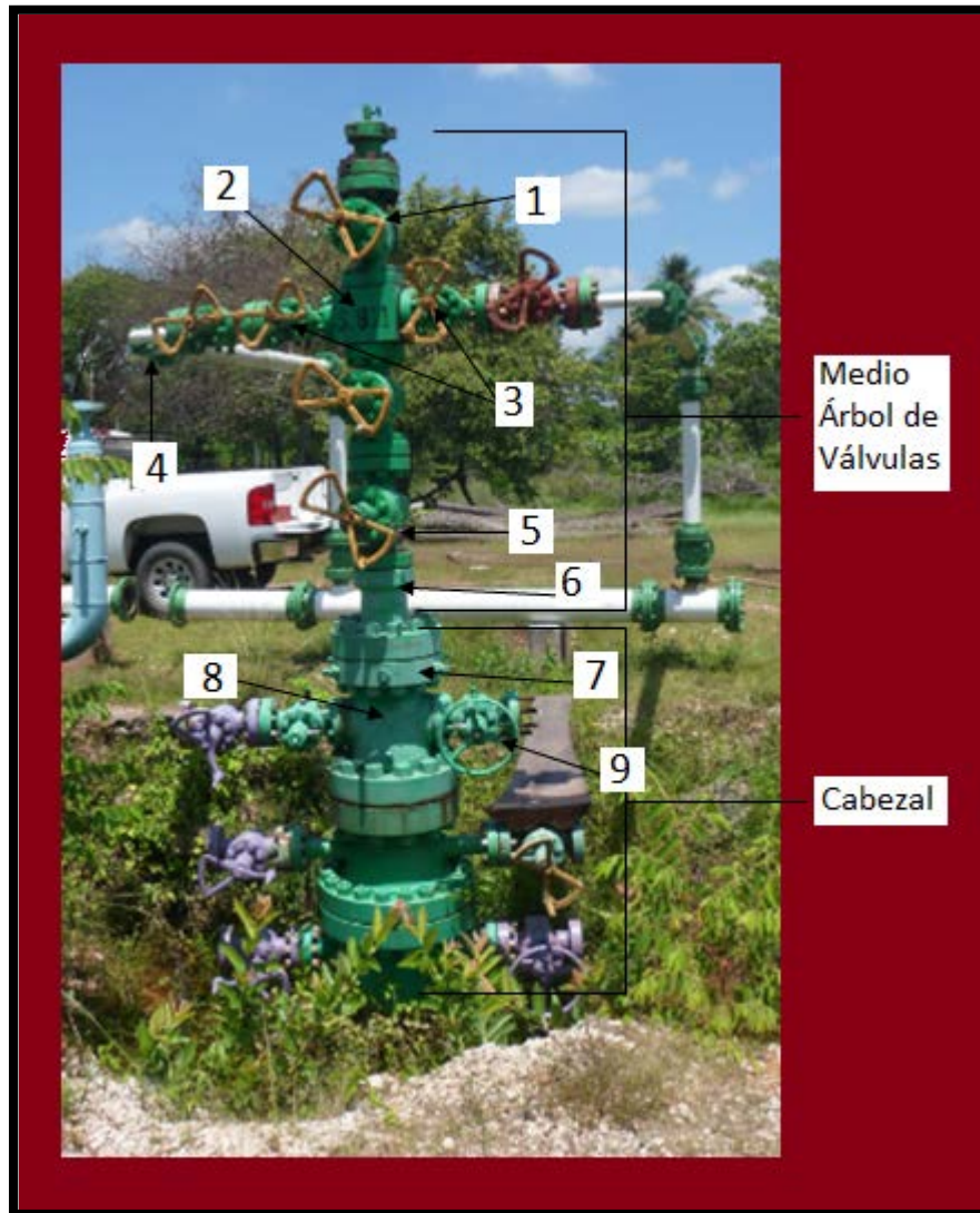
Figura 2.22 Árbol de Válvulas , Activo Samaria Luna, Villahermosa, Tabasco.
