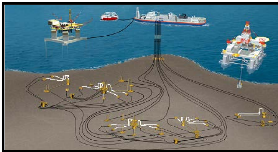
Figura 2.33 Jumpers del Pozo.
