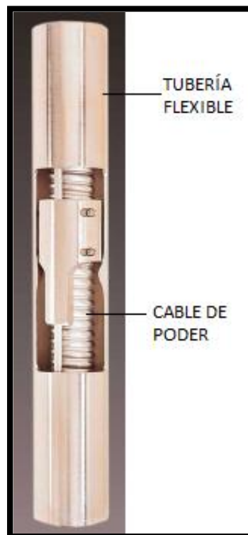
Figura 3.10 BEC bajado con TF con cable interno.
