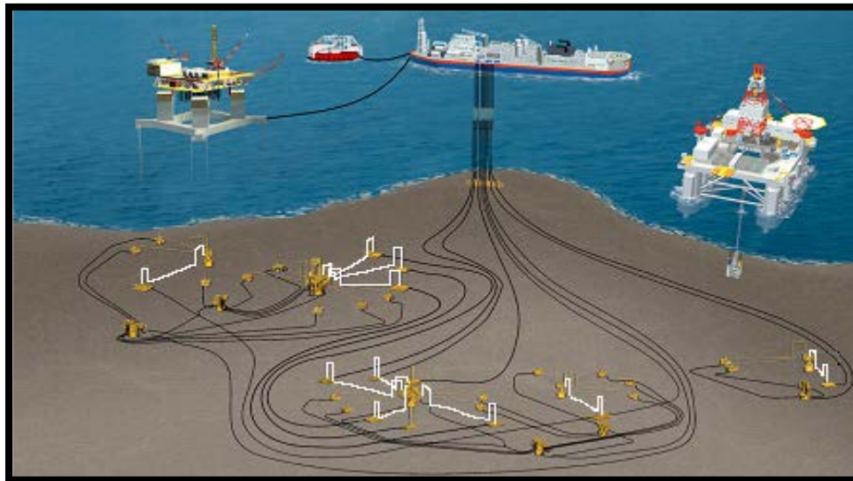
Figura 2.34 Jumpers de Línea de Flujo.
