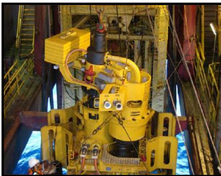
Figura 3.5 Sistema unido listo para la instalación en el lecho marino (Módulo de bombeo).
