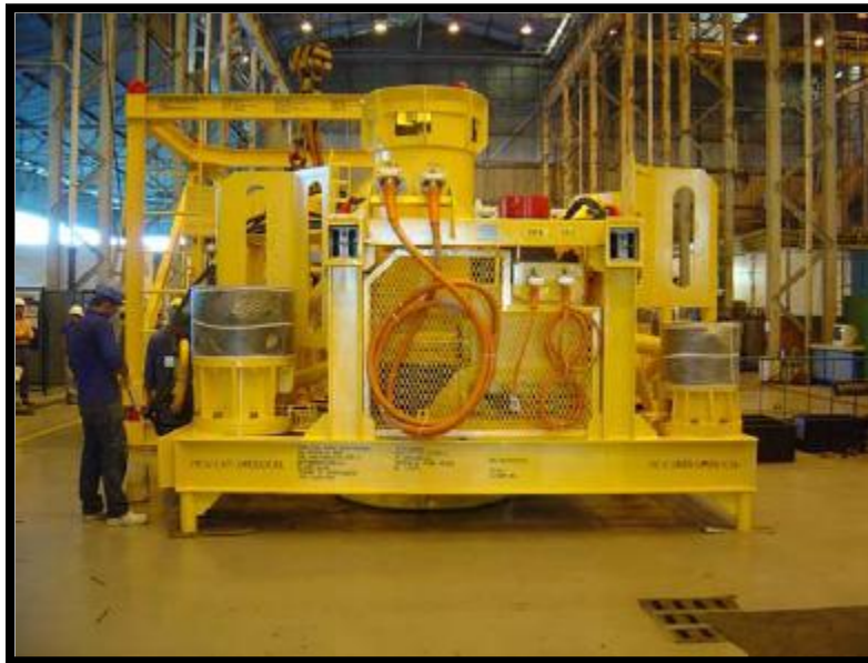
Figura 3.4 Base del adaptador de la bomba (PAB).
