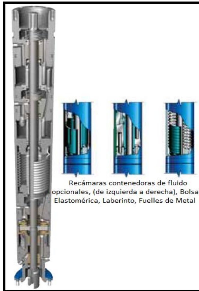
Figura 3.20 Protector Avanzado del Motor con Fuelles de Metal.
