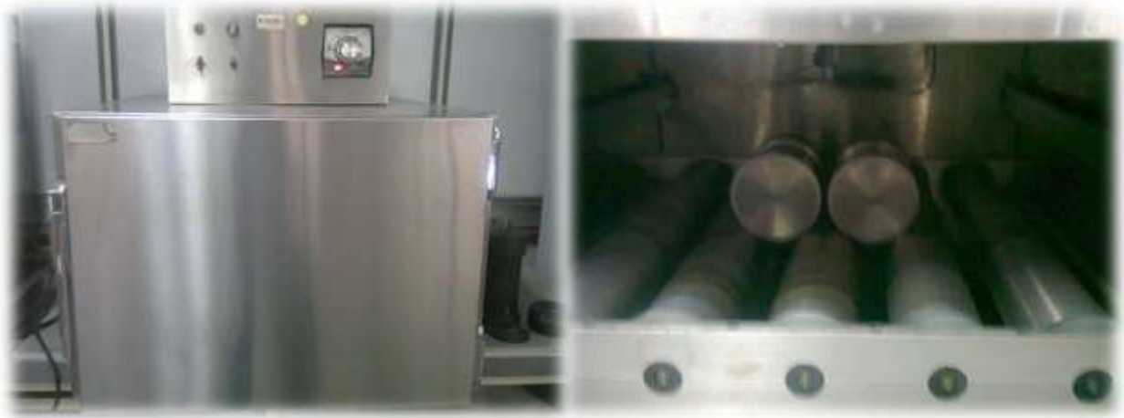
Figura 4.6 Izquierda, Horno Rolador Calentado a 120 °C, Derecha, Muestras de Fluido dentro el Horno Rolador
