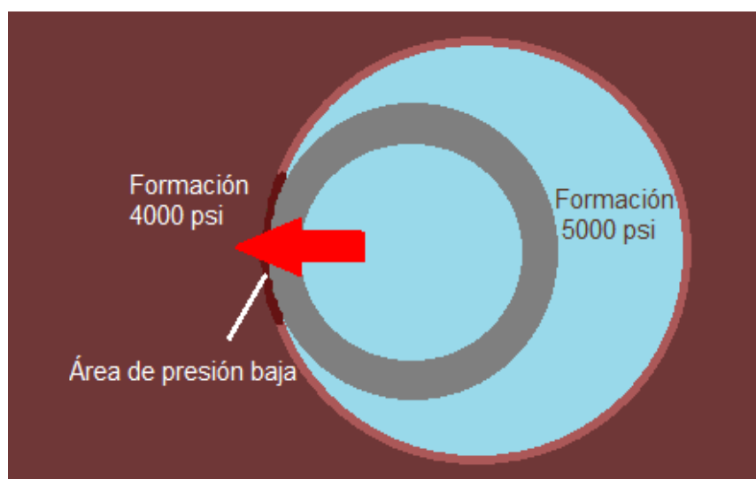
Figura 1.5 Pegadura por Presión Diferencial
