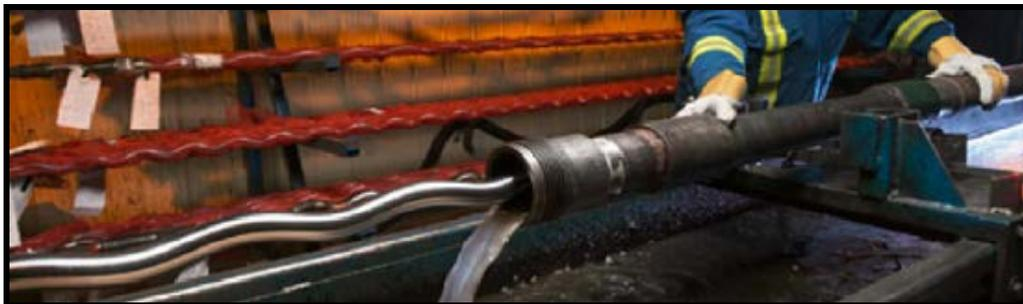
**Imagen 6.8. Introducción de un rotor en el estator de una bomba próxima a instalarse.**
