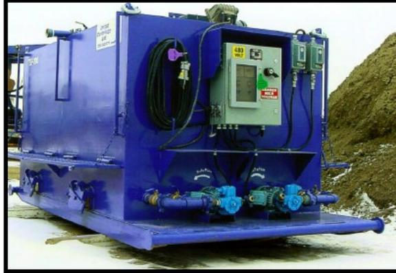
**Imagen 5.6. Tanque almacenador de polímeros para inyección.**
