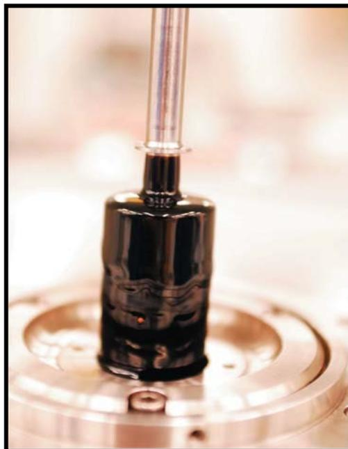
**Imagen 3.10. Medición de la viscosidad de crudo con un reómetro. Los reómetros miden los cambios producidos en la viscosidad con la variación de la tasa de flujo.**
