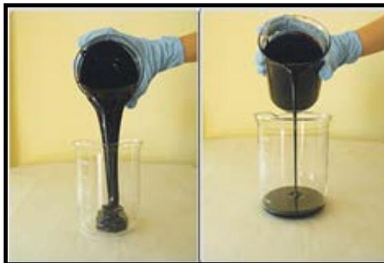
**Imagen 7.19. Notable contraste de viscosidad entre una muestra de aceite normal, y una muestra de aceite mejorado a partir de BRV.**
