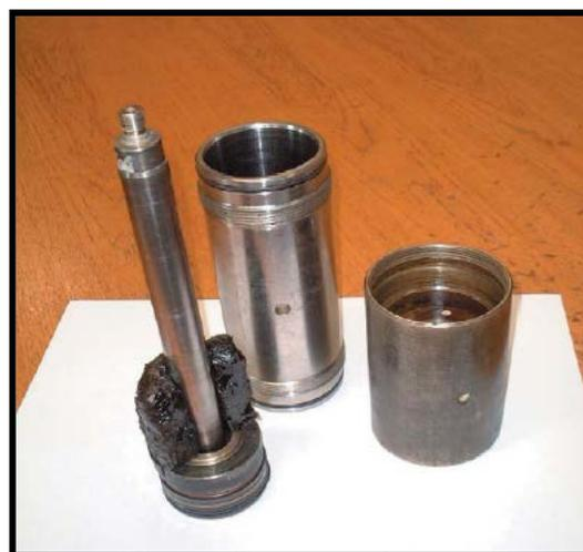
**Imagen 3.7. Muestra de aceite pesado obtenida mediante una celda MDT.**
