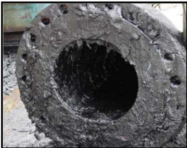
**Imagen 2.7. Depósitos de asfáltenos en tuberías.**
