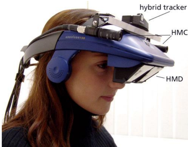
Figura III.XXXIII Visiocasco que muestra dispositivo de localización, HMC y HMD. 112
