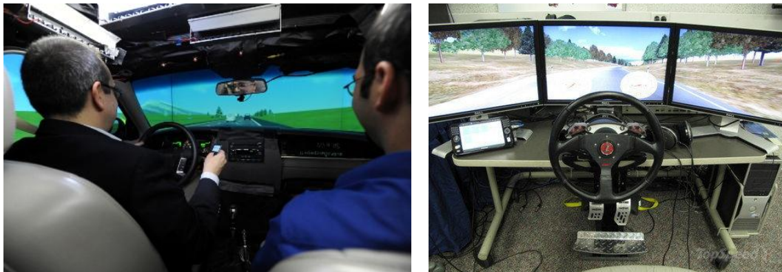
Figura III.XXXVI Simulador para entrenamiento en el manejo de Ford 118
