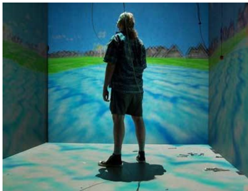
Figura III.XVII Sistema Proyectivo o CAVE de Realidad Virtual. Dibuja imágenes en el piso y en las paredes entregando una inmersión total. 70
