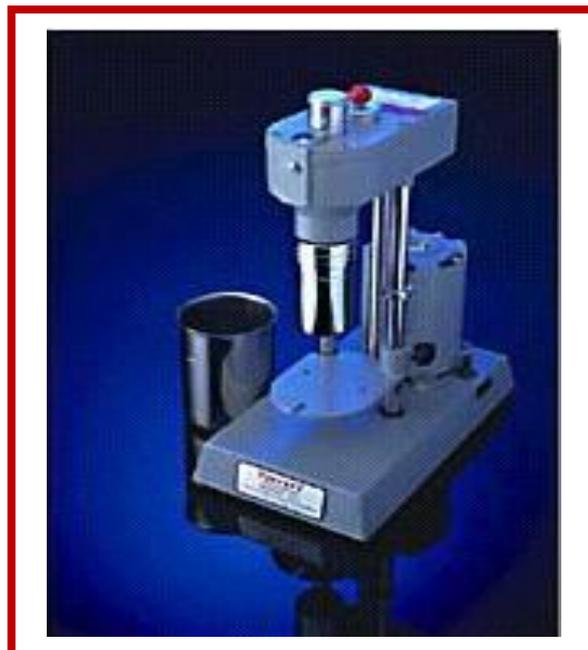
**Figura 2.11. Viscosímetro Rotacional Fann 35.**
