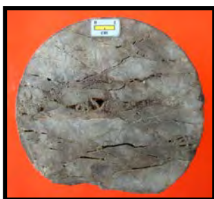
Wackestone con desarrollo de cavidades de disolución y fracturas también con disolución.
