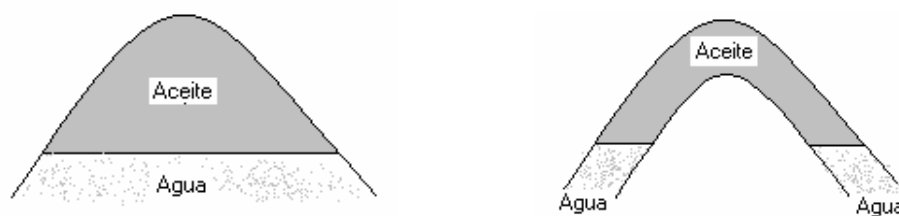
Figura 1.23.- Representación de conexión hidráulica por debajo del yacimiento
