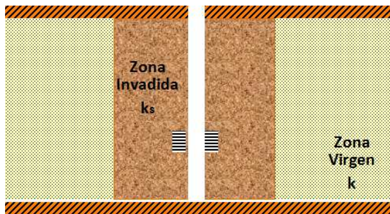
Fig. 18 Modelo de una formación dañada, con dos zonas de permeabilidad diferente.
