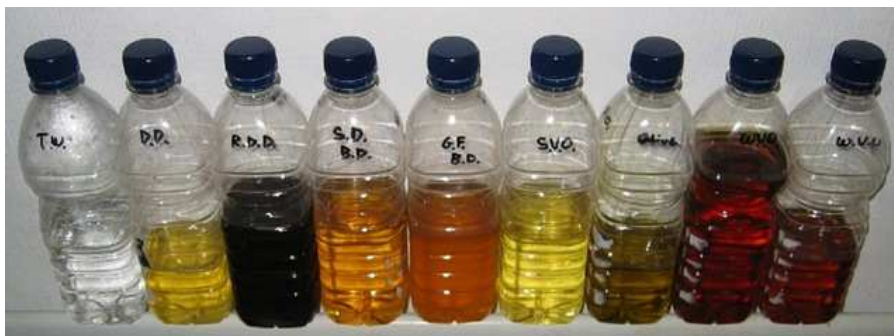
Fig. 5 Muestras de condensado del separador y de fondo de pozo.
